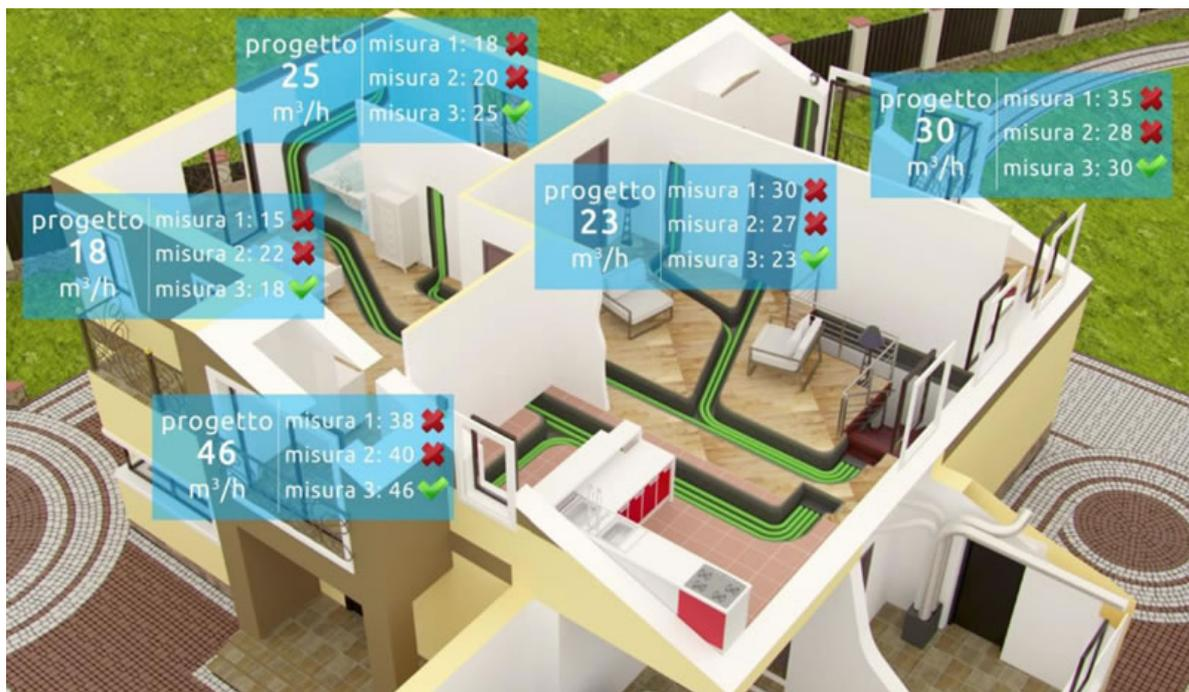
Risulta evidente come il tempo necessario alla misurazione e alla regolazione di un impianto sia di fondamentale importanza per rendere la taratura un processo veloce ed efficiente, senza rinunciare alla necessaria precisione di misura.
